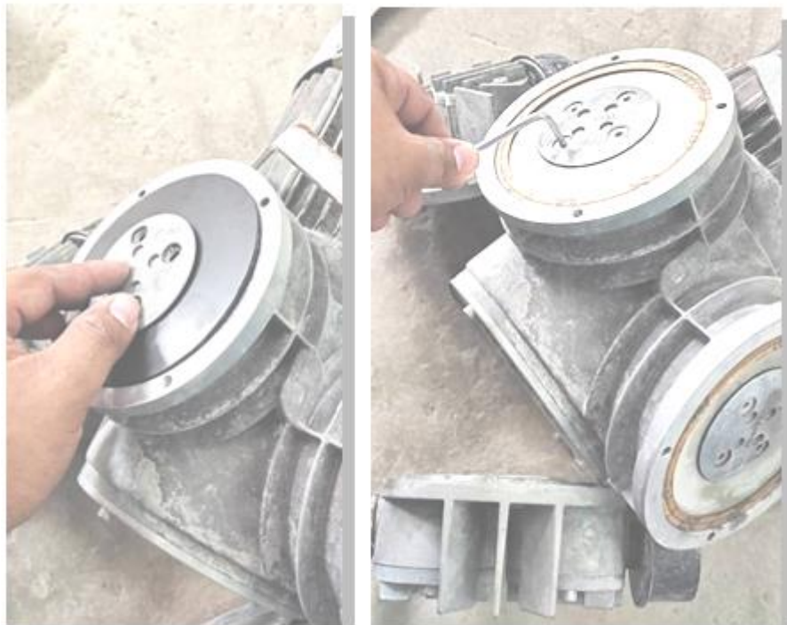
2.9 ประกอบฝาปิดลูกสูบ และ ประกอบเครื่องกลับ ดำเนินการทดสอบการใช้งาน
