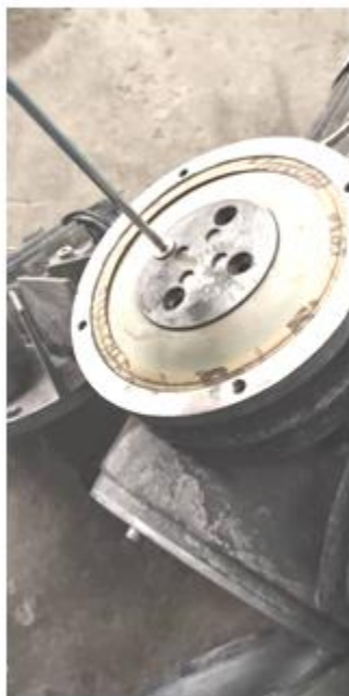
2.6 ถอดแผ่น เมมเบรน ด้านบน และแผ่นเมมเบรนติกเนส ด้านล่างออก (ตรวจสอบดูว่า แผ่นเมมเบรนติกเนส เสื่อมสภาพหรือไม่ หากยังปกติดี สามารถงานได้อีกระยะ)
