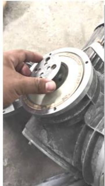
2.6 ถอดแผ่น เมมเบรน ด้านบน และแผ่นเมมเบรนติกเนส ด้านล่างออก (ตรวจสอบดูว่า แผ่นเมมเบรนติกเนส เสื่อมสภาพหรือไม่ หากยังปกติดี สามารถงานได้อีกระยะ)
