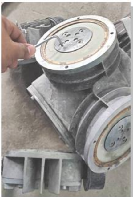
2.6 ถอดแผ่น เมมเบรน ด้านบน และแผ่นเมมเบรนติกเนส ด้านล่างออก (ตรวจสอบดูว่า แผ่นเมมเบรนติกเนส เสื่อมสภาพหรือไม่ หากยังปกติดี สามารถงานได้อีกระยะ)
