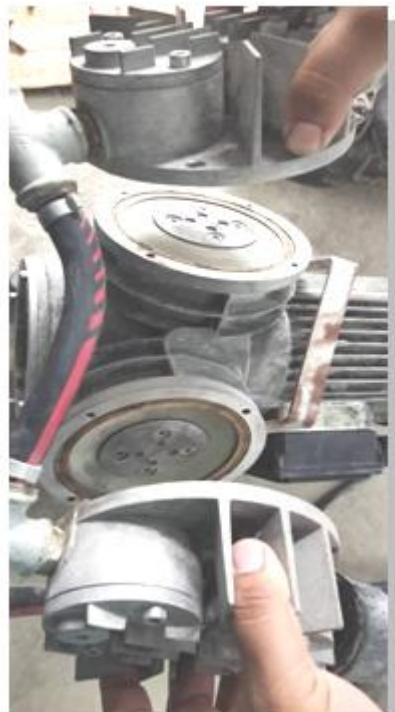
2.5 ใช้ประแจ 6 เหลี่ยม ขันเฟลทประกบยึดแผ่นเมมเบรนออก
