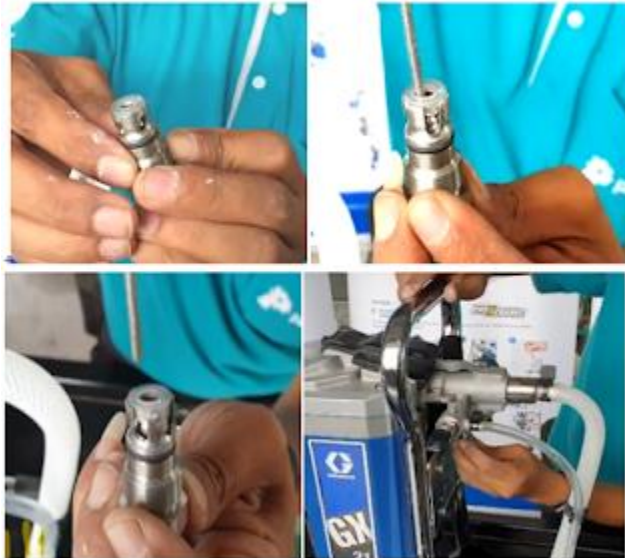
6. ตรวจเช็ควาล์ว สปริง ของวาล์ว ยังทำงานได้ตามปกติ โดยการปิด - เปิด ดู
