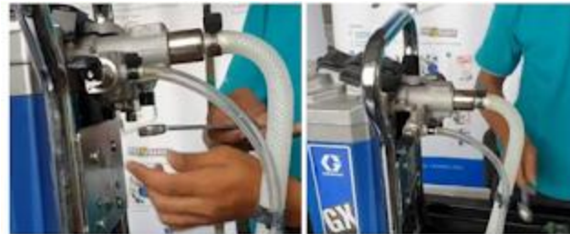
6. ตรวจเช็ควาล์ว สปริง ของวาล์ว ยังทำงานได้ตามปกติ โดยการปิด - เปิด ดู
