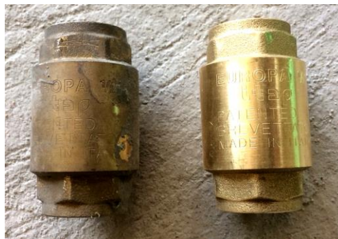
วาล์วกันกลับ ตัวที่ผ่านการใช้งาน มีการสึกหรอ ตรงขั้วจับดีส
